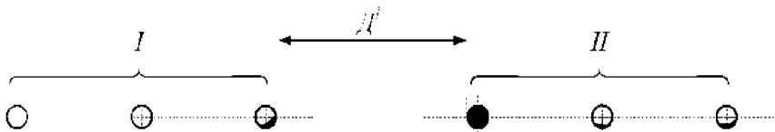
Рисунок 4.2.7 – Найменші відстані по горизонталі між струмовідними частинами різних кіл у разі обслуговування одного кола за невимкненого іншого.
