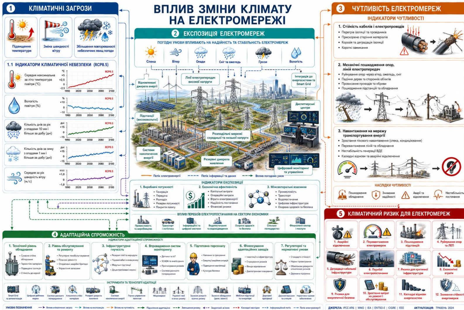
Рис. 5.9 - Схема причинно-наслідкових ланцюгів впливу зміни клімату на електромережі передачі та розподілу електроенергії
